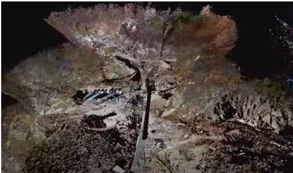
岩手県宮古市姉吉地区の津波被災地を地上型レーザースキャナで精密測量した結果
