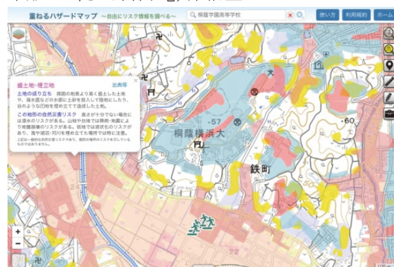
図 1: 「重ねるハザードマップ」を使って桐蔭学園高等学校周辺の切土と盛土, および洪水浸水想定区域と指定緊急避難場所をマッピングした地図.
