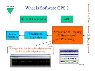
を詳細にシミュレーションすることを可能にし、ソフトウェアシミュレーションによる受信機の設計/開発、性能評価を初めて実現した。これは衛星以外のさまざまな測位システムの設計・計画、性能評価にも適用できるほか、一つの受信機で非常に多くの信号を一度に処理できる新しいタイプの受信機開発への道も開き、測位システム研究に新しい分野を開拓した。これまで衛星を中心とした測位システムの教育は、ハードウェア受信機をブラックボックスとして、その使い方を演習することに終始していたが、ソフトウェア測位システム実際に学生が受信機の内容を自由に変更し、その影響をその場で試験することが可能になり、全く新しい教育/演習スタイルへと変わりつつある。
