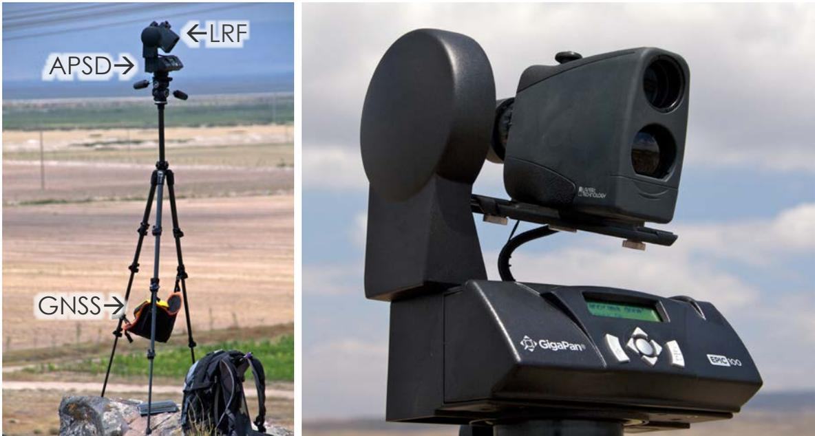
図 1. LRF+APSD システム。APSD は三脚上に設置され、その器械点座標は直下に置いた GNSS 測位（コード/フェーズによる後処理補正）で取得している。
